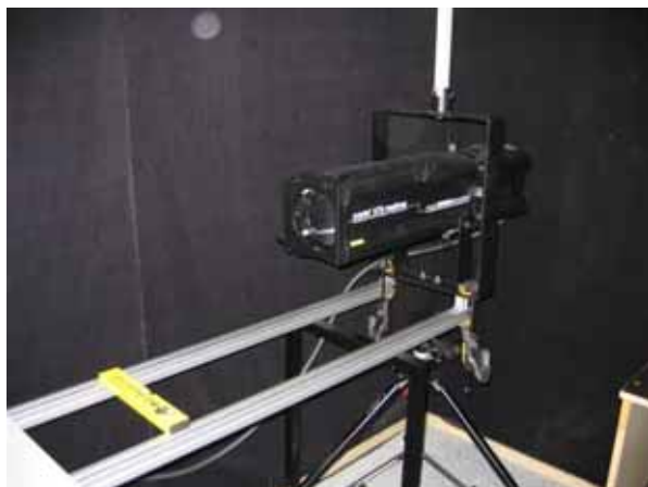
Slika 3: Svetlobni vir z ustreznimi lečami, ki omogočajo ustrezno ozek svetlobni snop (sončni simulator oziroma reflektor)
